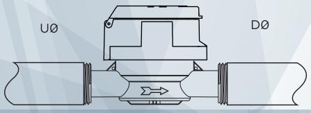
Aucun tronçon rectiligne n'est nécessaire ni sur l'entrée ni sur la sortie de notre compteur Atlantis.
