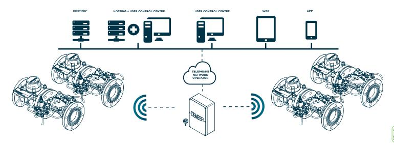
Il modello Demeter GPRS consiste in unità remote dotate di modem GPRS.
