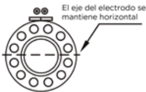
Livello di installazione
